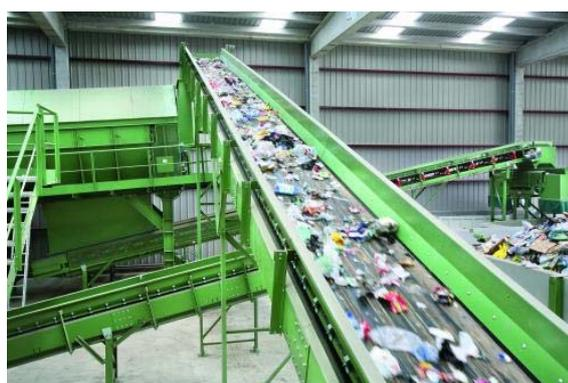
Por su parte, en una línea de clasificación tipo encontramos la siguiente maquinaria Separadores balísticos (2); aspiradores; electroimanes; separadores ópticos (2) e inductores de Foucault. Aproximadamente 7 máquinas por planta. Sumarían por tanto 56 máquinas en las 8 plantas de conteo previstas.
